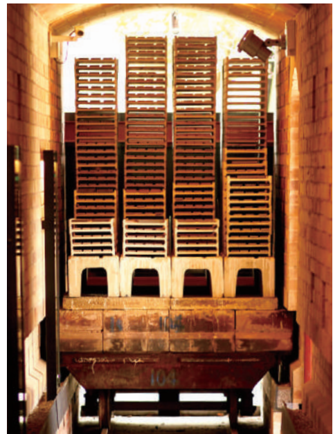
図1. トンネル窯。この写真は伊奈製陶(現LIXIL)のタイル製造用トンネル窯である。ここで行われたタイル実験およびそこで行われた質向上のための効率的な手法は、まさにタグチメソッドのルーツといえる。
